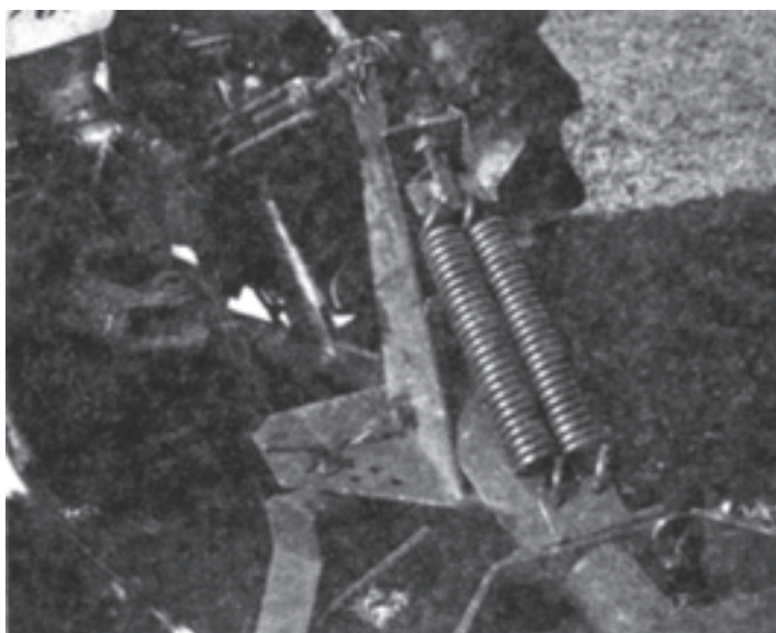
شکل ۱۱-۵- فنرهای شناوری شانه چرخ
