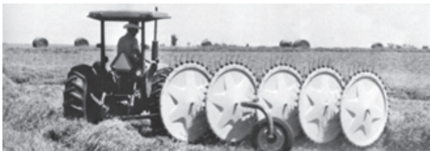
شکل ۹-۵- شانه چرخشی کششی با چرخ انگشتی مخصوص نقاط بادخیز
