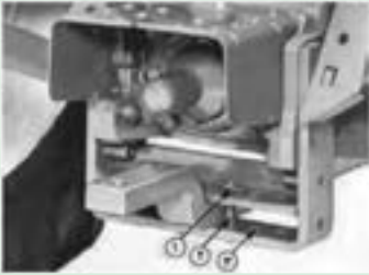
شکل ۲-۳- تنظیم وضعیت عرضی مالبند
