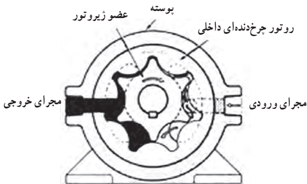
شکل ۳-۷- طرز کار پمپ ژیراتور
