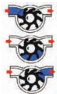
شکل ۱۶-۳- طرز کار پمپ
