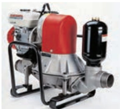
شکل ۳-۲۹- پمپ آب دیافراگمی
