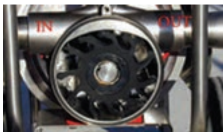
شکل ۱۵-۳- پمپ پره‌ای لاستیکی
