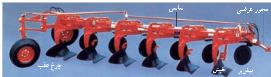
شکل ۱-۳- گاو آهن نیمه سوار شش خیشه
