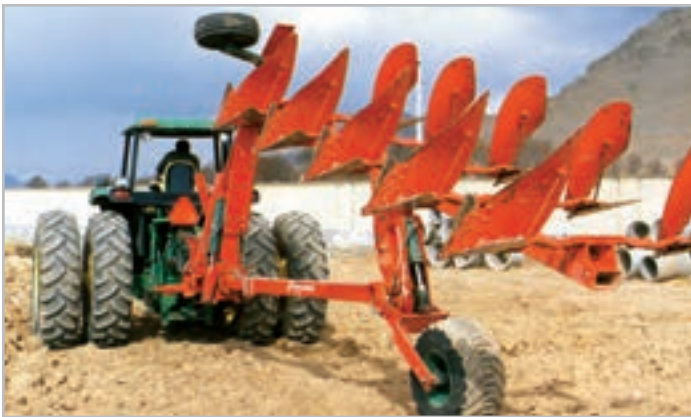
شکل ۱-۱- گاوآهن دوطرفه در وضعیت حمل
