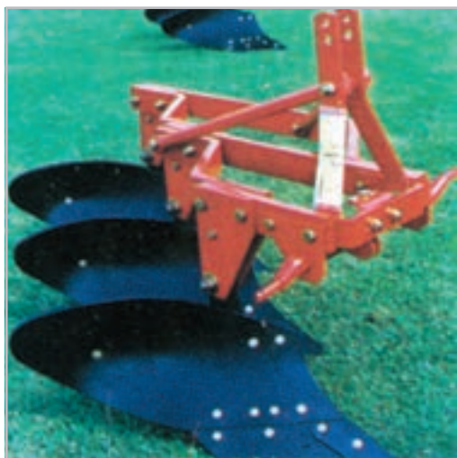
شکل ۱۹-۱- گاو آهن برگردان دار سه خیشه سوار
