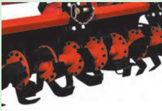
شکل ۲۲-۱. نقاط اتصال تیغه‌ها به فلانج
