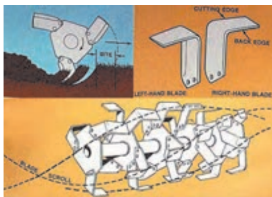
شکل ۱۵-۱. آرایش مارپیچ تیغه‌های گاواهن دوار
