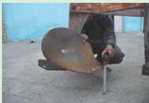
شکل ۳۰-۱. اندازه‌گیری فاصله تیغه جهت تراز عرضی
