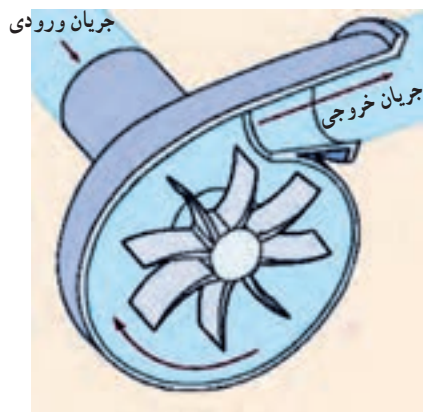
شکل ۲-۱- مسیر حرکت سیال در پمپ گریز از مرکز
