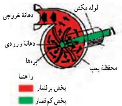
شکل ۲-۱- مسیر حرکت سیال در پمپ گریز از مرکز
