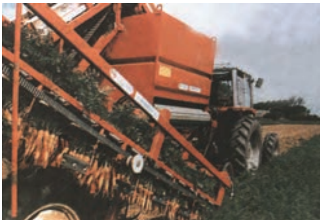
شکل ۸-۷ - برداشت مکانیزه هویج
