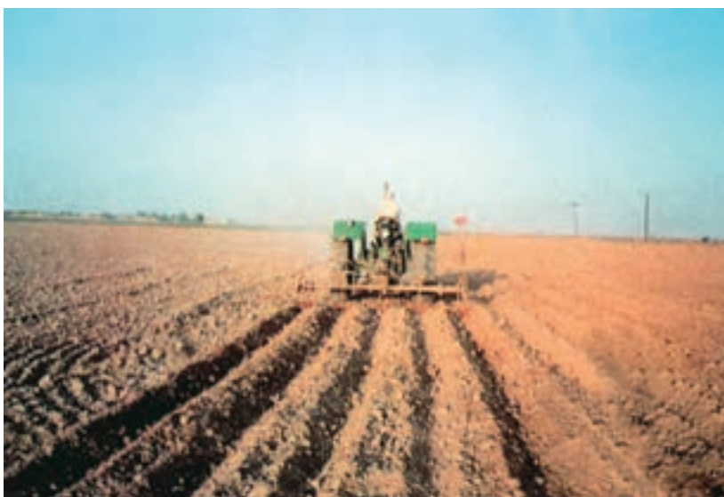
شکل ۱۴-۲ - دستگاه فاروئر بعد از بذر پاشی ایجاد فارو می‌نماید.
