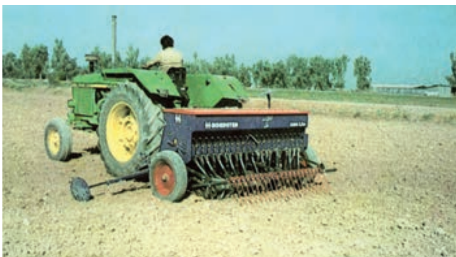
شکل ۱-۲- بذرکار خطی کار در حال کاشت گندم
