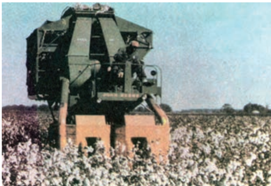
شکل ۶-۳- ماشین مخصوص برداشت وش پنبه
