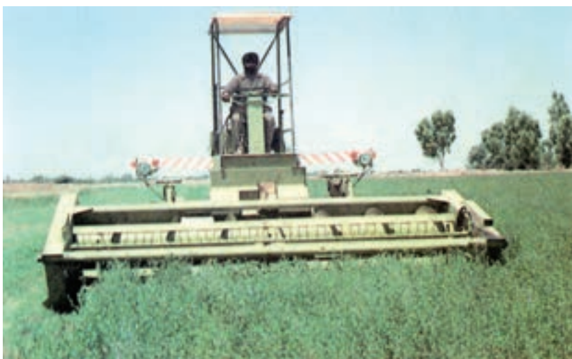
شکل ۶-۲- برداشت یونجه به وسیله‌ی دستگاه سواتر
