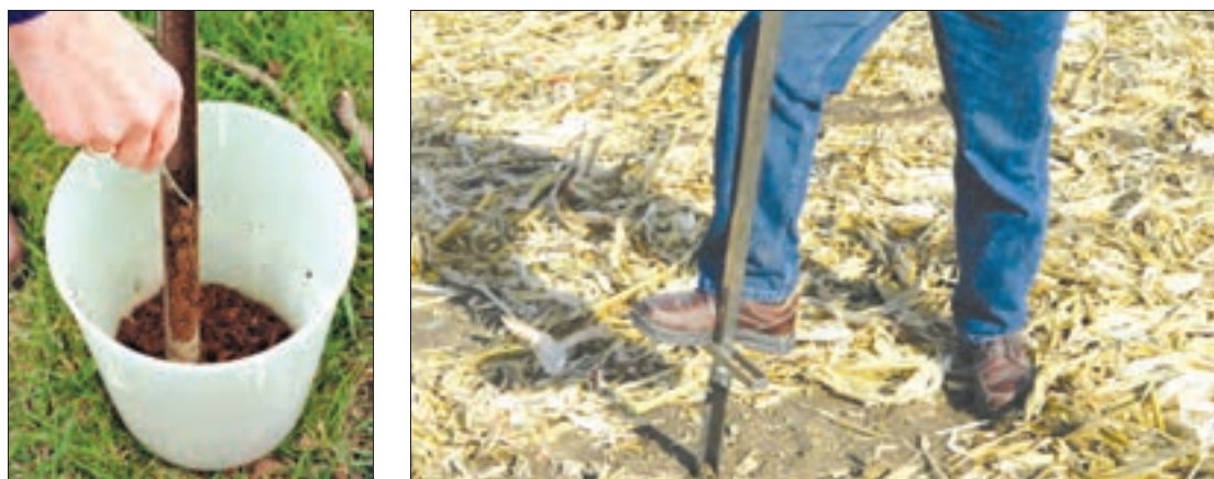
شکل ۹-۲- برداشت نمونه خاک با اگر
