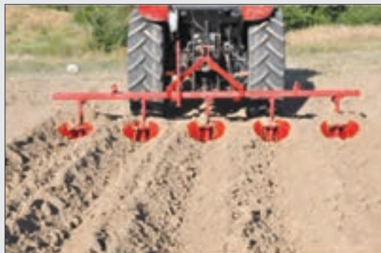
شکل ۳۲-۵- شیارکش در حال ایجاد شیار
