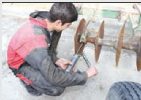
شکل ۲۱-۴- گریس کاری دیسک
