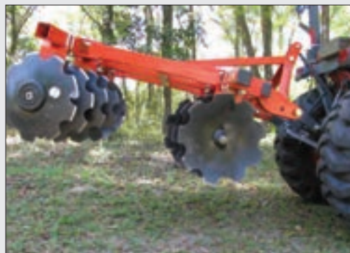
شکل ۲۹-۴- مالبند بلند و اتصال سه نقطه
