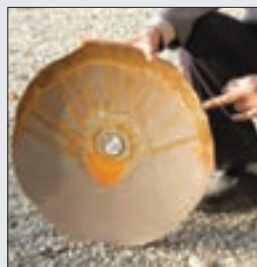
شکل ۱۸-۴- شکستگی نقطه اتصال و بشقاب
