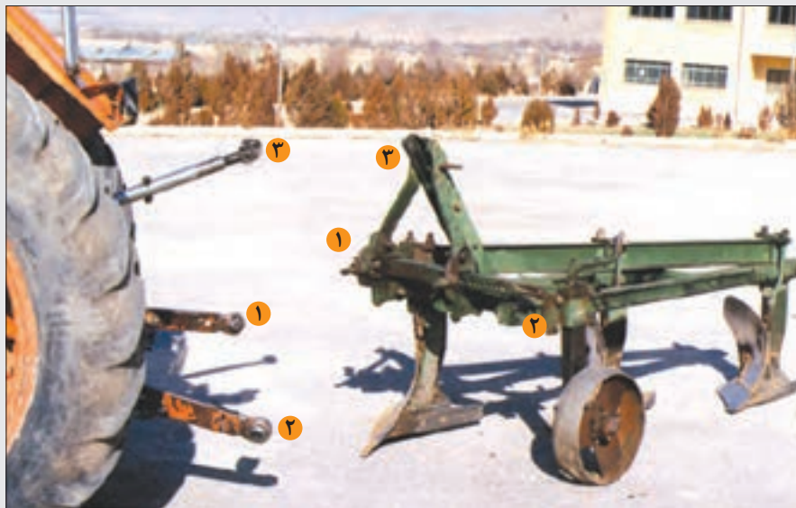
شکل ۲۸-۳- اتصال گاواهن به تراکتور
