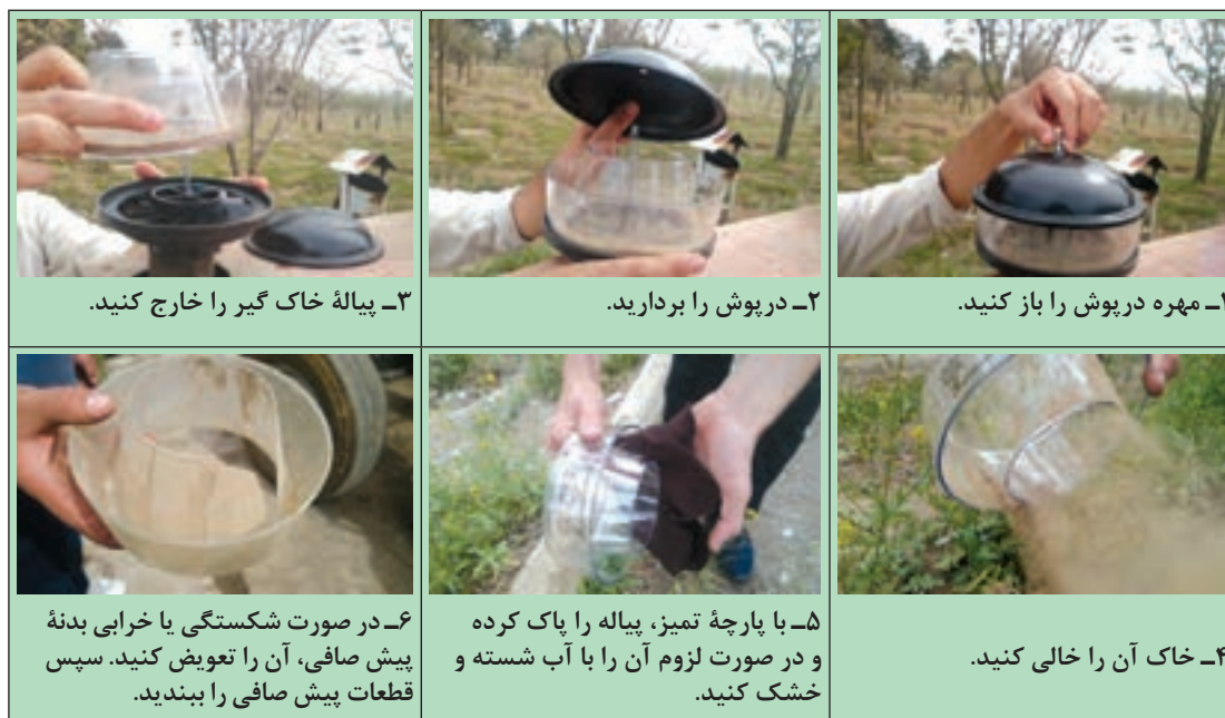
شکل ۳۱-۱- مراحل تمیز کردن پیش صافی
