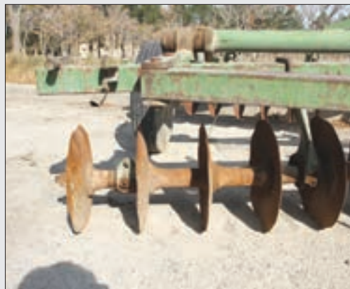
شکل ۱۹-۴ یاتاقان خراب بشقاب
