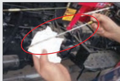
شکل ۹-۱ میله اندازه گیری
