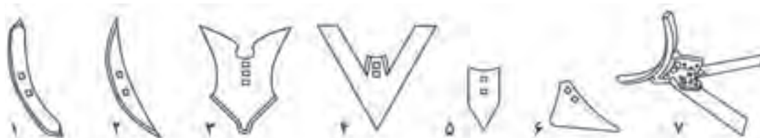
۱- قلمی ۵- بیلچه ای ۲- دندانه ای ۶- کفشکی ۳- شیار بازکن ۷- قلمی پنجه غازی مرکب ۴- پنجه غازی
