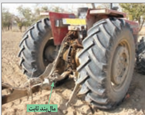
شکل ۱۶-۵- نقطه اتصال در صاف کننده کششی
