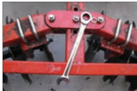
شکل ۴-۲۸- تغییر زاویه استقرار ردیف بشقاب‌ها روی شاسی
