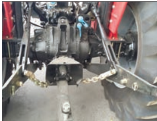
شکل ۳۲-۳- زنجیر تنظیم تعادل یا نوسان گیر
