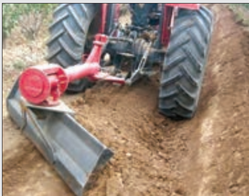
شکل ۲۷-۲ زاویه تیغه و ریزش خاک در چاله
