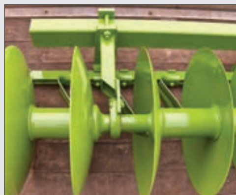
شکل ۲۰-۴ اجزای محور دیسک
