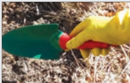
شکل ۲-۲- برداشت نمونه خاک برای تعیین رطوبت خاک
