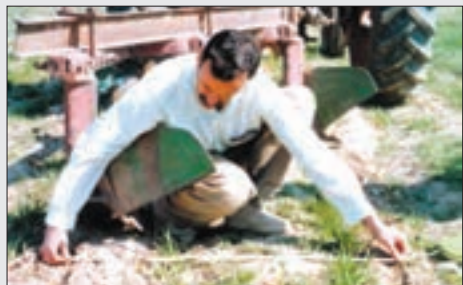
شکل ۳۷-۳- اندازه‌گیری عرض کار گاواهن برگردان دار
