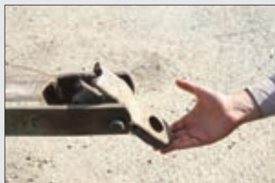
شکل ۱۸-۴- شکستگی نقطه اتصال و بشقاب
