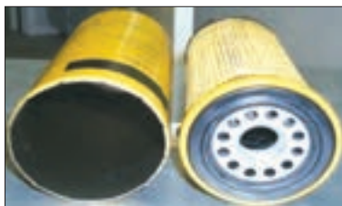
شکل ۳۶-۱- صافی گازوئیل
