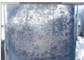
شکل ۱-۴۴- رادیاتور با شبکه کثیف
