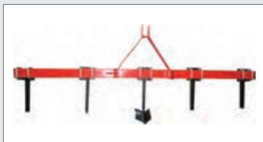
شکل ۳۱-۵- شیارکش با واحدهای عامل متعدد
