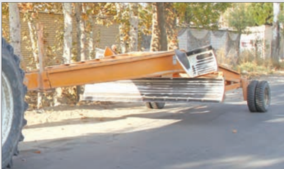
شکل ۱۹-۵- زمین‌صاف‌کن در وضعیت جابه‌جایی
