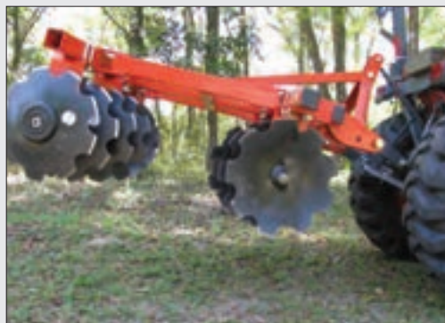
شکل ۲۹-۴- مالبند بلند و اتصال سه نقطه
