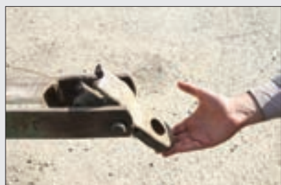
شکل ۱۸-۴- شکستگی نقطه اتصال و بشقاب
