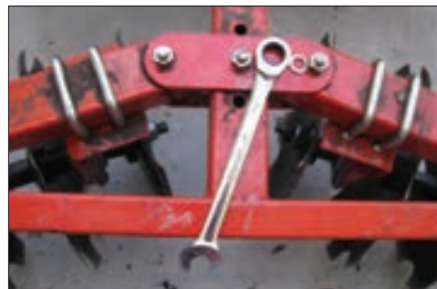
شکل ۴-۲۸- تغییر زاویه استقرار ردیف بشقاب‌ها روی شاسی
