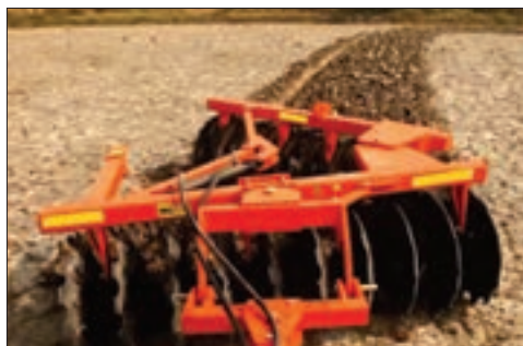
شکل ۴-۲۸- تغییر زاویه استقرار ردیف بشقاب‌ها روی شاسی
