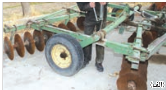
شکل ۴-۲۶- دیسک با تنظیم هیدرولیکی چرخ (الف) و تنظیم دستی (ب)
