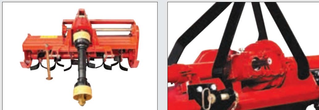
شکل ۲۵-۴- گاردان و محور توان دهی
