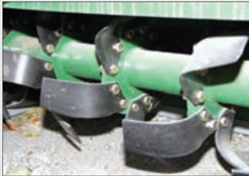
شکل ۲۲-۴ وضعیت درپوش و تیغه‌ها در گاوآهن دوار
