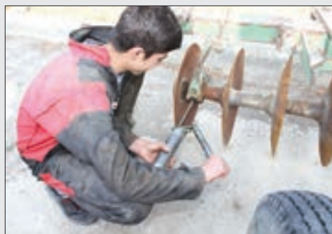
شکل ۲۱-۴- گریس کاری دیسک
