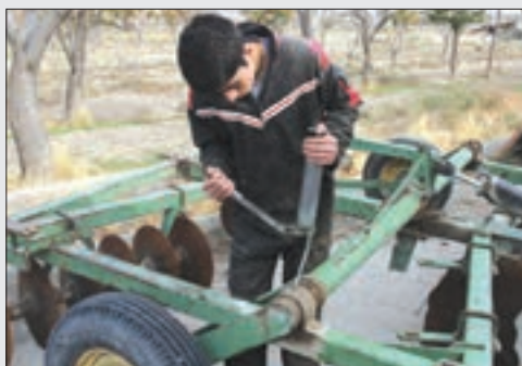
شکل ۲۱-۴- گریس کاری دیسک
