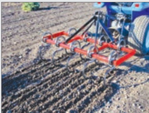
شکل ۳۳-۴ کولتیواتور با شاخه های فنری
