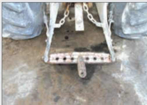
شکل ۲۹-۴- مالبند بلند و اتصال سه نقطه
