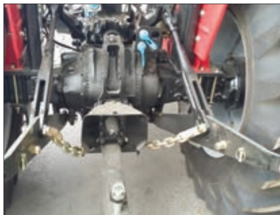
شکل ۳۲-۳- زنجیر تنظیم تعادل یا نوسان گیر
