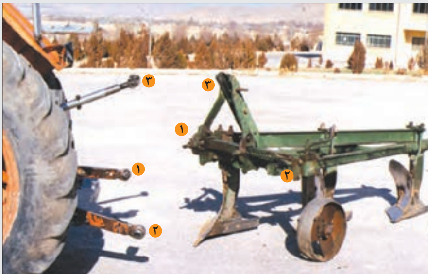
شکل ۲۸-۳- اتصال گاواهن به تراکتور
