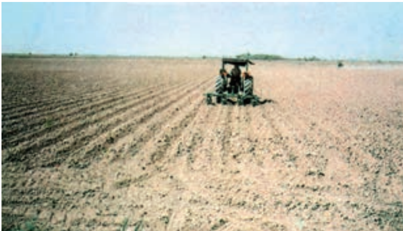
شکل ۱۳-۲ - دستگاه ردیف‌کار ذرت در حال کاشت ردیفی
