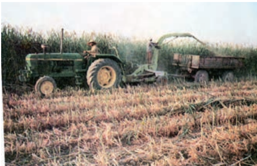
شکل ۱۹-۲- عملیات برداشت ذرت علوفه‌ای با چاپر
