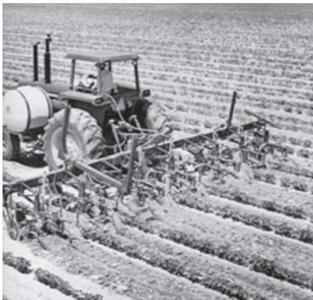
شکل ۲۶-۳- سم‌پاشی همراه با وجین
