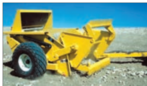
شکل ۲۰-۲- ماشین های سنگ جمع کن و اسکرپپر
