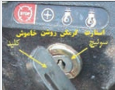
شکل ۱۴-۱ سوئیچ و وضعیت‌های آن
