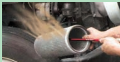
شکل ۳۵-۱- تمیز کردن صافی خشک با فشار هوا
