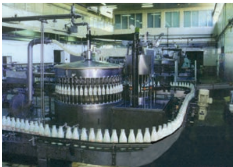
شکل ۸-۱- پرکن پیستونی
