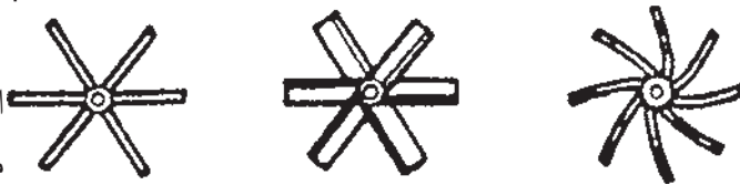
شکل ۲-۳ - انواع همزن‌های توربینی
