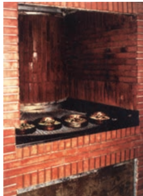
شکل ۲۸-۵ - فر دوار در حال پخت پیتزا
