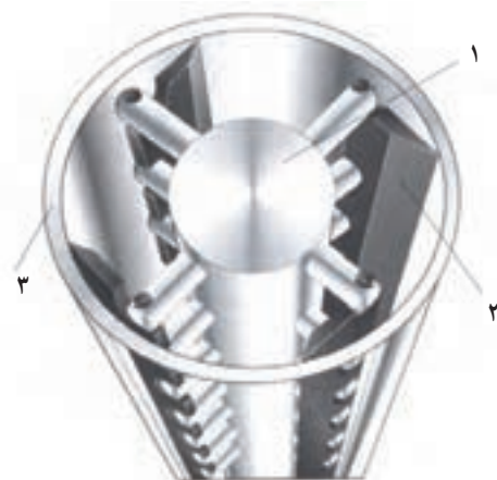
۱- محور چرخنده ۲- تیغه ۳- بدنه استوانه
