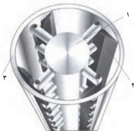
۱- محور چرخنده ۲- تیغه ۳- بدنه استوانه
