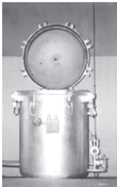
شکل ۲۲-۵ دیگ پخت تحت فشار
