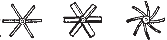
شکل ۲-۳ انواع همزن‌های توربینی
