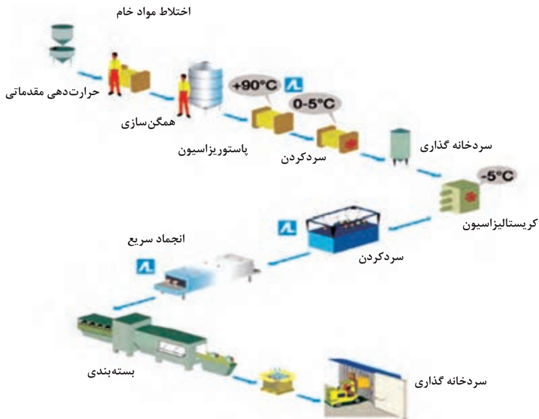
شکل ۳-۸ - فرایند تولید بستنی
