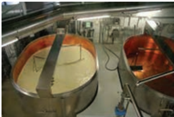
شکل ۳-۳- مخزن اختلاط بستنی
