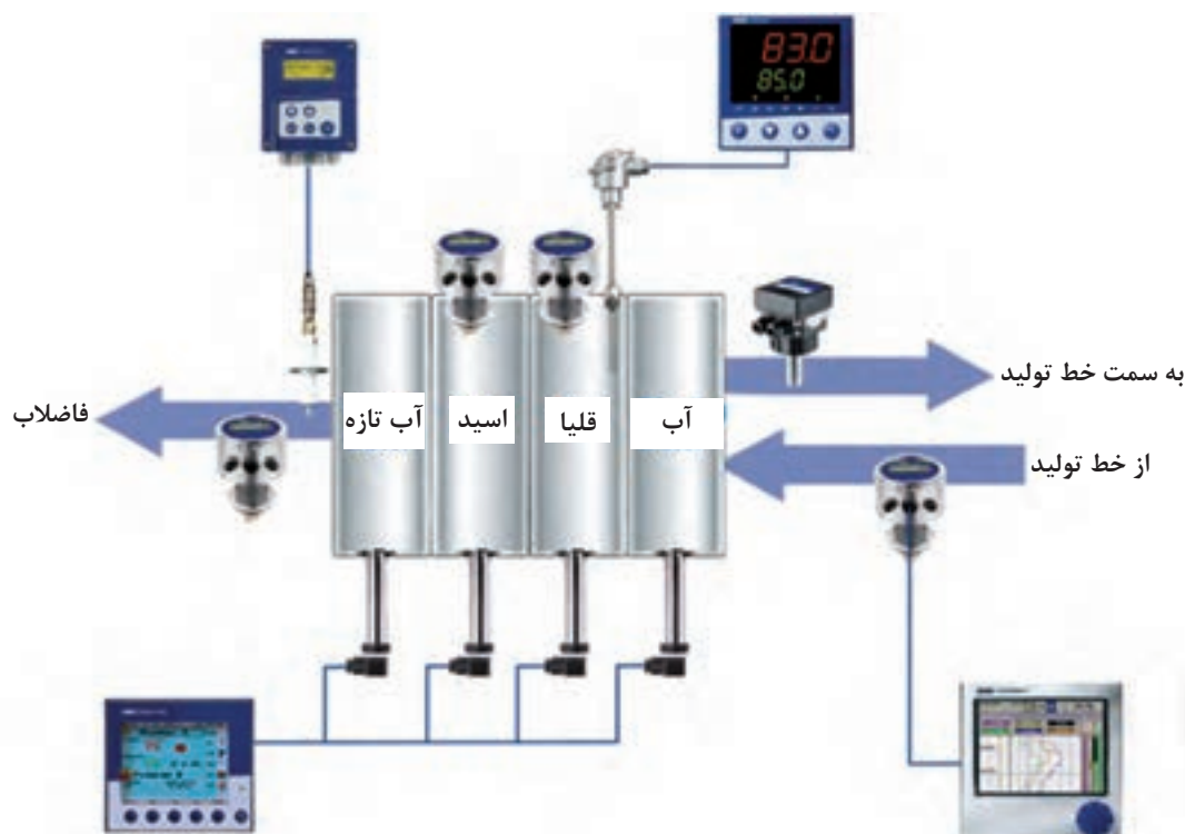
شکل ۱-۲۲- سیستم CIP
