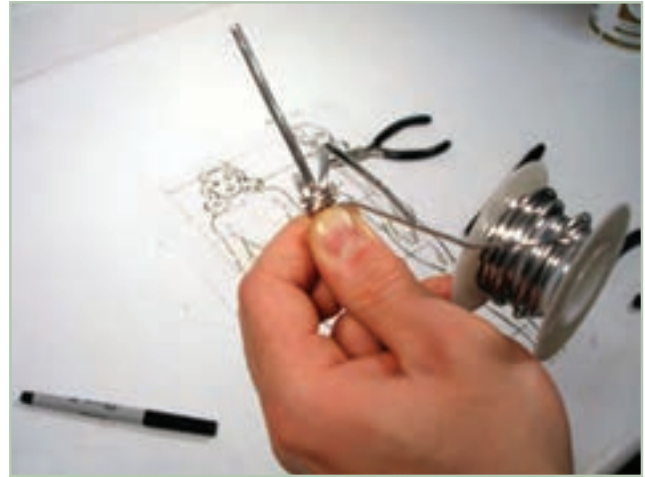
تصویر ۱-۶۹- نحوه ایجاد حلقه ها جهت تولید فرم یا گره ، سیم
