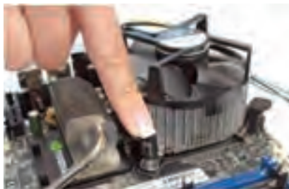
شکل ۲-۲- نحوه قرارگیری پردازنده
