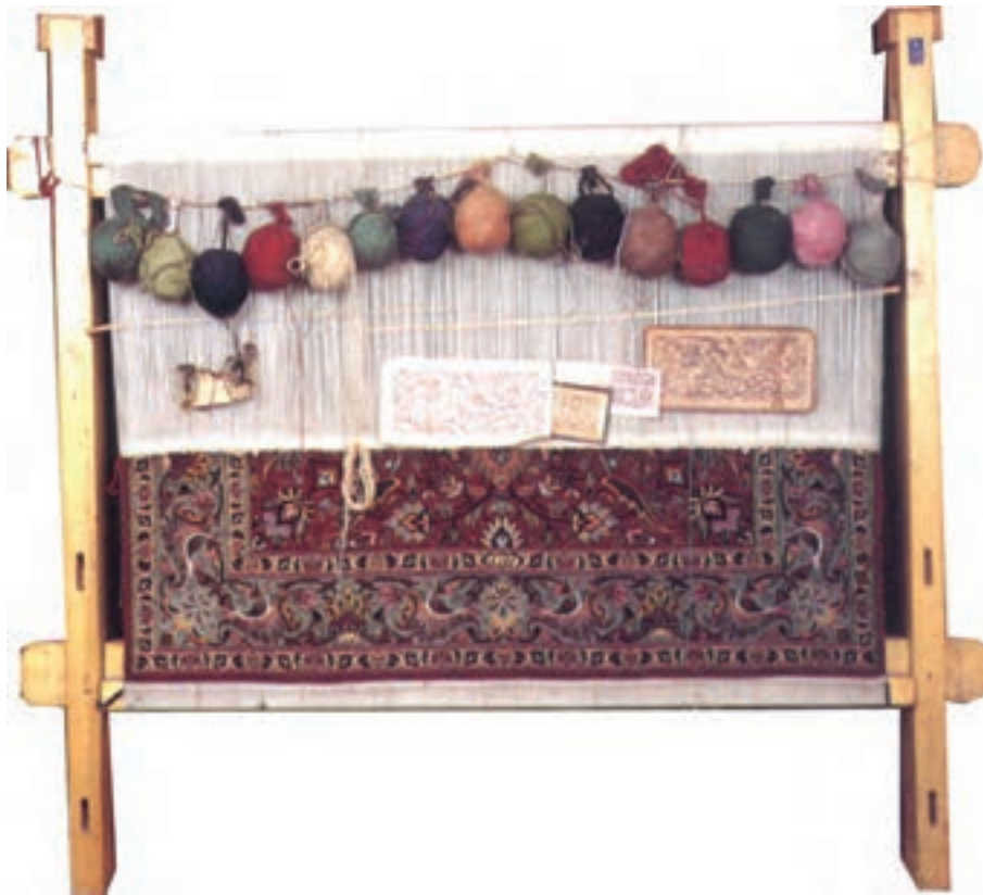
تصویر ۴-۱۲- دستگاه قالی بافی عمودی تبریزی
