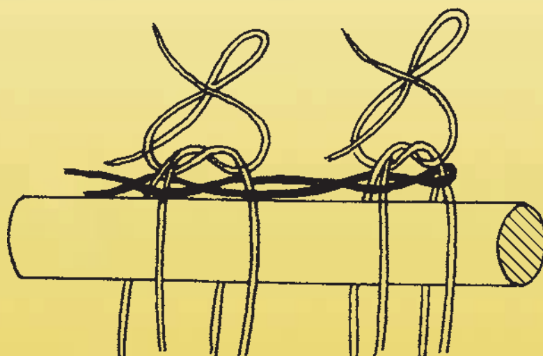
تصویر ۱۲-۱۶- چگونه بستن تارهای چله به سردار
