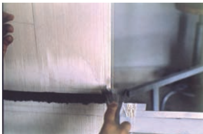
تصویر ۵- ۱۸- عبور پود نازک و شانه
