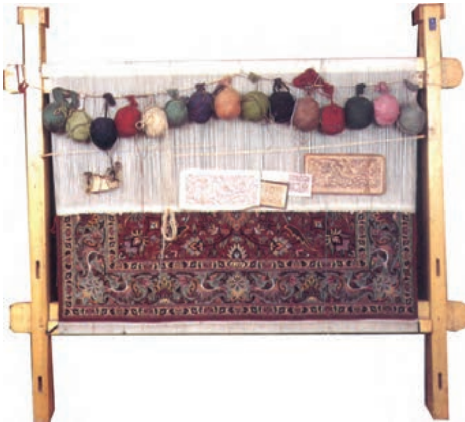
تصویر ۴-۱۲- دستگاه قالی بافی عمودی تبریزی
