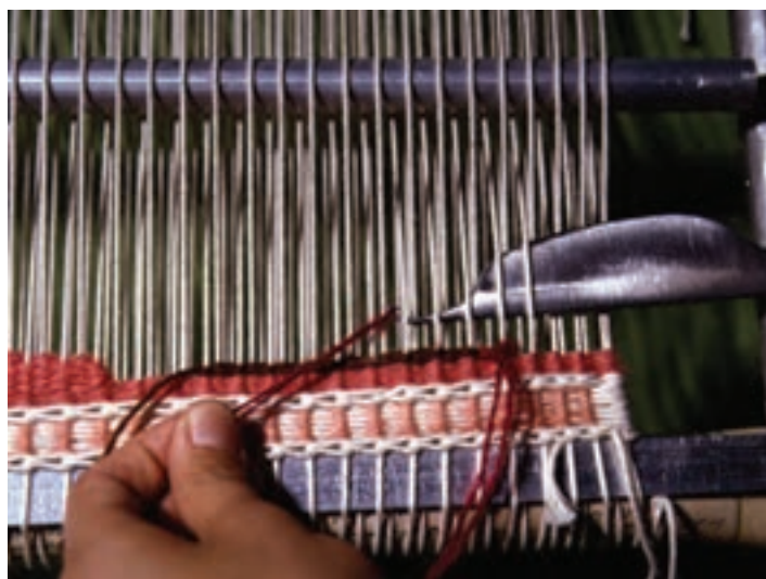
تصویر ۴-۱-ب - عبور پود با استفاده از قلاب
