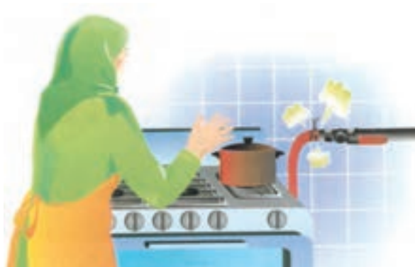
ب) طریقه نصب غلط
