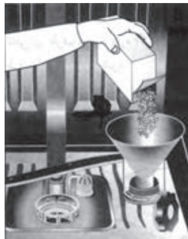
شکل ۹-۱۶- طریقه ریختن نمک در ماشین ظرفشویی اتوماتیک
