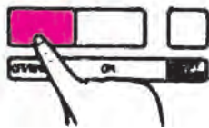
شکل ۹-۸- وصل کلید مربوط به دور معکوس موتور
