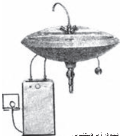
شکل ۲-۵- آبگرمکن نصب شده در زیر دستشویی
