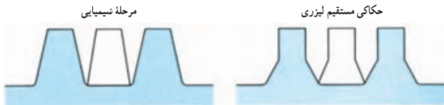
شکل ۹-۴- مقایسه ایجاد نقش برجسته یک پلست چاپ فتوپلیمر تولید شده در یک مرحله فتوگرافیک/شیمیایی با پلست (لاستیکی) حکاکی شده توسط لیزر
