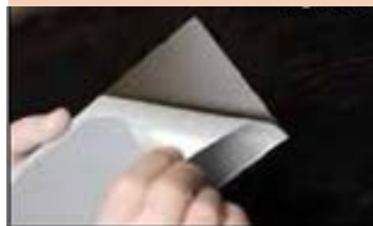
شکل ۴-۱۵- جدا کردن روکش محافظ
