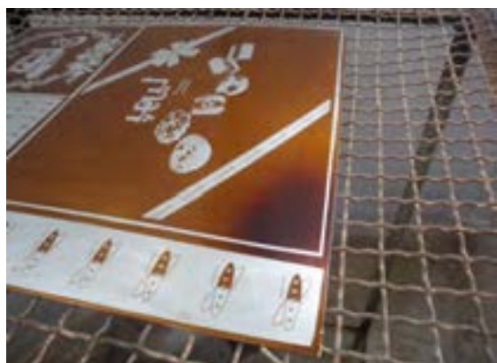
شکل ۴۸-۴- حرارت دادن کلیشه
