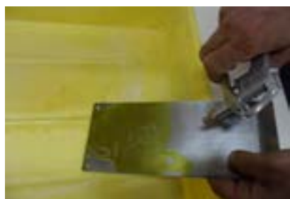
شکل ۴-۲۰- خارج کردن داروی ظهور از گودی ها
