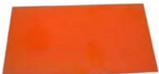
شکل ۴-۸- کلیشه خام فتوپلیمر
