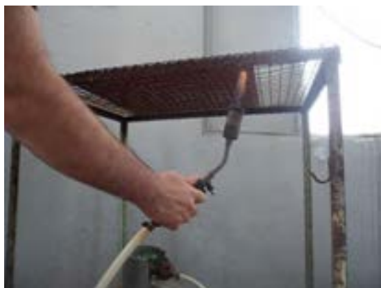
شکل ۴۷-۴- حرارت دادن کلیشه
