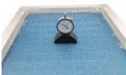
شکل ۵-۲۶ کشش‌سنج توری
