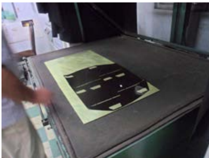
شکل ۴-۴۳- قراردادن فیلم بر روی کلیشه
