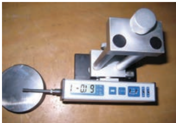
b - زبری سنج در حال اندازه‌گیری زبری
