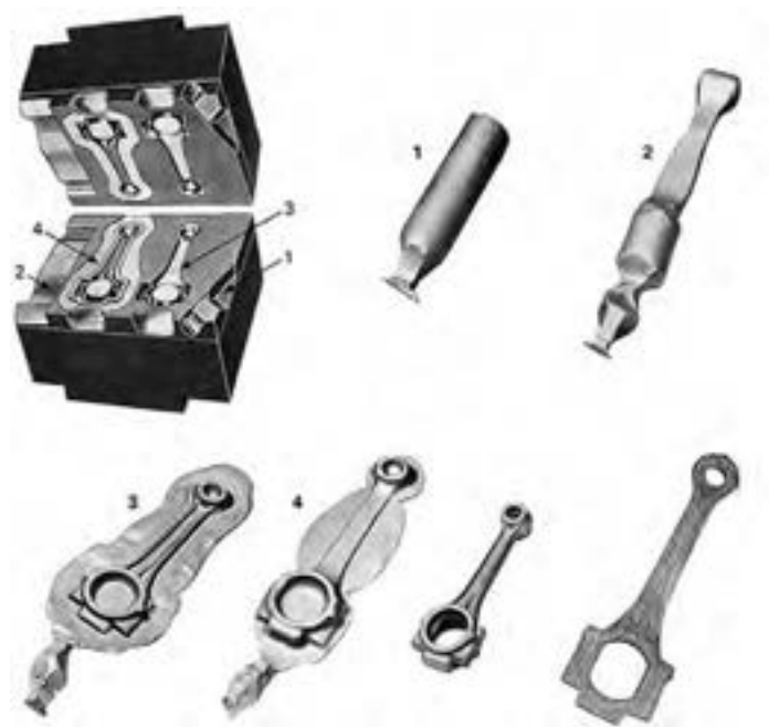
شکل ۲-۱۰ - مراحل ساخت یک شاتون بوسیله قالب بسته
