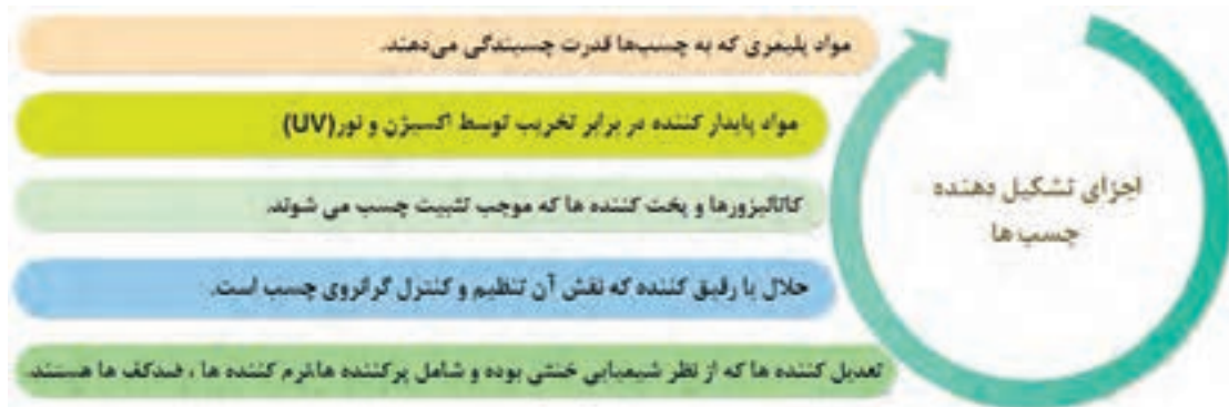
شکل ۴۰-۴- اجزای تشکیل دهنده چسب
