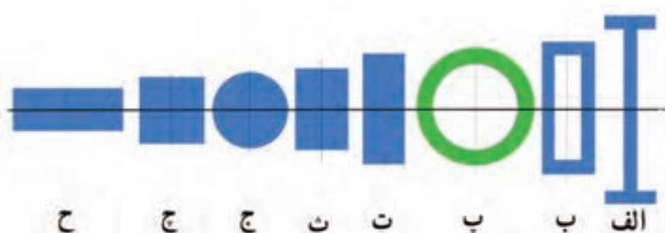
شکل ۲۴-۶- انواع سطح مقطع در خمش
