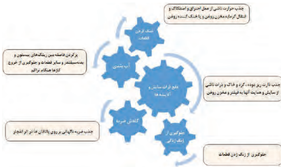
شکل ۵۱-۴- وظایف روانکار در موتور
