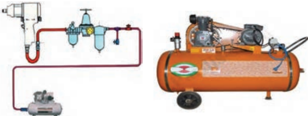
شکل ۹-۳- دستگاه کمپرسور و مدار پنوماتیک
