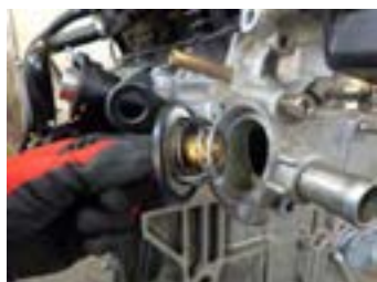
۳- ترموستات معیوب خارج شود.
