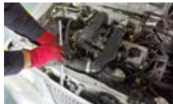
۳- شمع های موتور باز شود.
