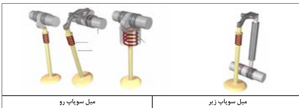
شکل ۸-۱- انواع مکانیزم حرکت سوپاپ
