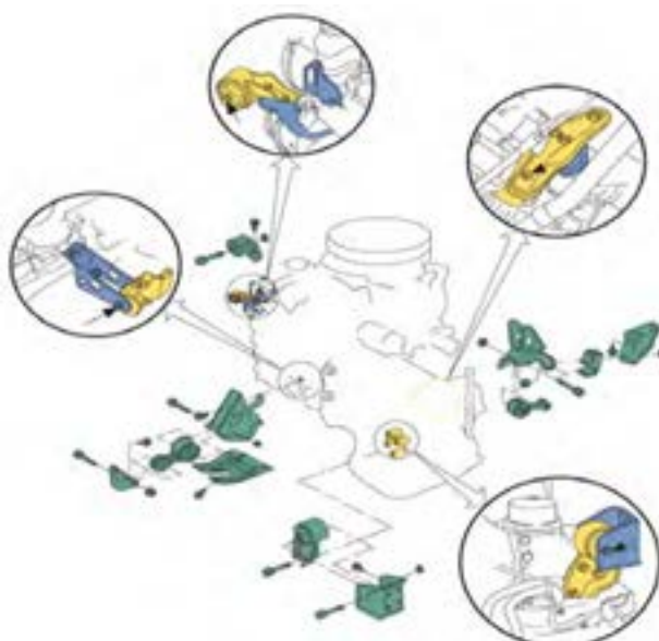
شکل ۹-۴ - محل نصب دسته‌موتور
