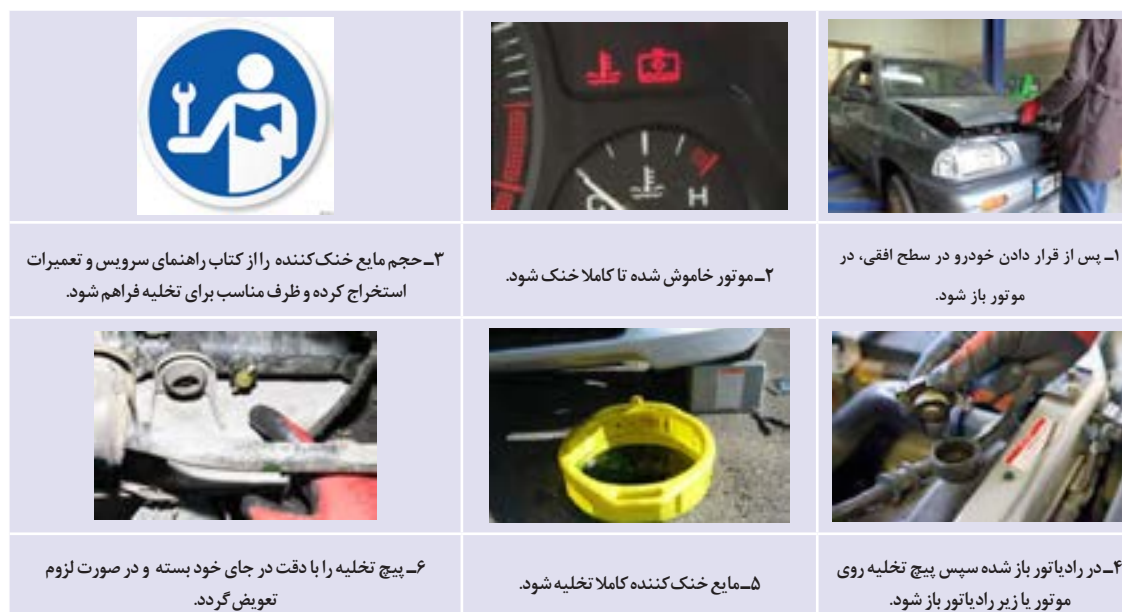
شکل ۳۰-۷ تخلیه مایع خنک کننده موتور به روش دستی
