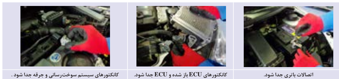
شکل ۹-۷ باز کردن قطعات و اتصالات الکتریکی از موتور
