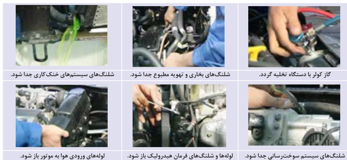
شکل ۹-۸ باز کردن لوله‌های ورودی هوا و شلنگ‌های متصل به موتور
