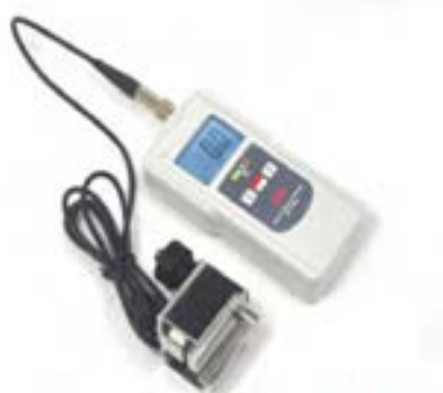
شکل ۴۵-۸- دستگاه کشش سنج تسمه تایم
