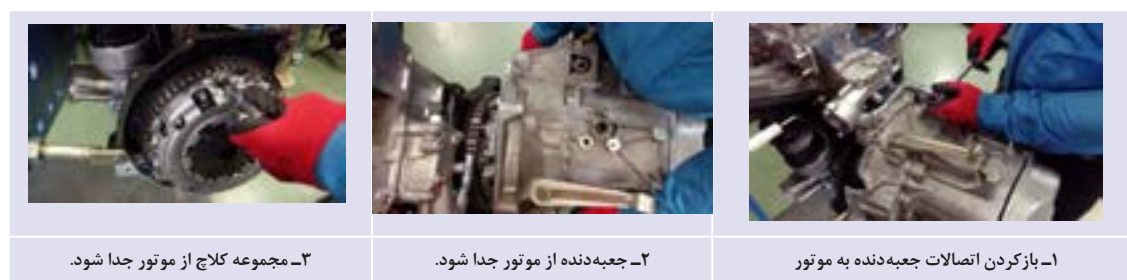
شکل ۹-۱۲- روش پیاده‌سازی موتور خودروی محرک جلو
