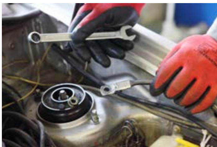
شکل ۹-۱۴- اتصال منفی یا اتصال بدنه قسمت موتور
