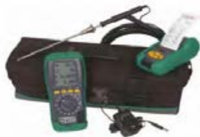
شکل ۲۰-۸- دستگاه آنالیز گازهای خروجی اگزوز
