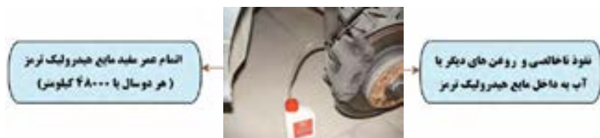
شکل ۹-۶- لزوم تخلیه کامل روغن هیدرولیک ترمز
