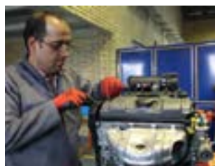
۸- خلاصی سوپاپ‌ها با فیلر کنترل و در سوپاپ‌ها بسته شود.
