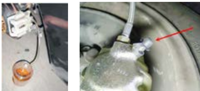
شکل ۱۰-۶- تخلیه مایع هیدرولیک ترمز به صورت دستی
