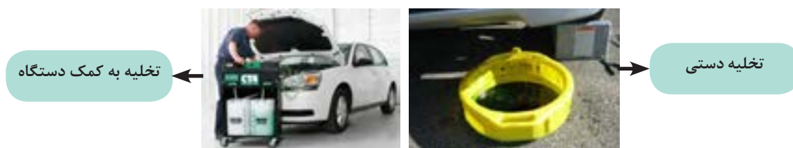
شکل ۲۸-۷ روش های تخلیه مایع خنک کننده
