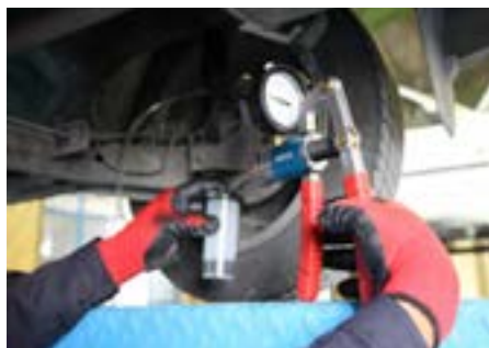
شکل ۱۱-۶- نمونه ای از دستگاه خلائی هواگیری سیستم ترمز
