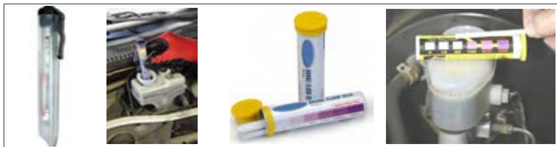
شکل ۶-۷- تست کیفیت مایع هیدرولیک ترمز
