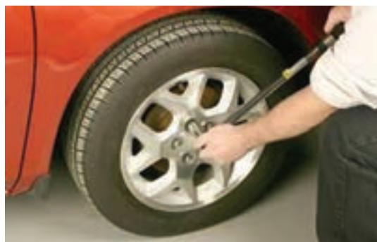
شکل ۴-۵- گشتاور لازم برای سفت کردن چرخ
