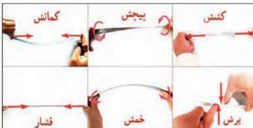
شکل ۴-۶- انواع بارگذاری روی خط کش فلزی
