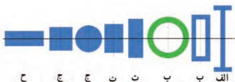
شکل ۲۴-۶- انواع سطح مقطع در خمش
