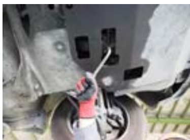
۴- پیچ تخلیه روغن جعبه دنده باز شود.
