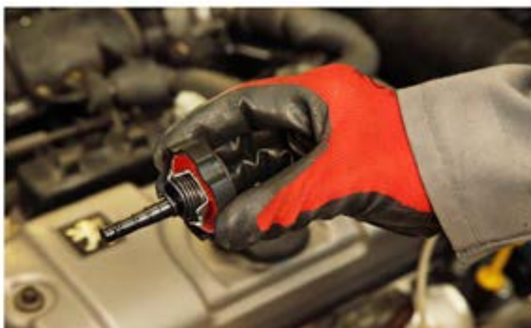
شکل ۵-۹- شاخص های روی درپوش مخزن مایع هیدرولیک فرمان
