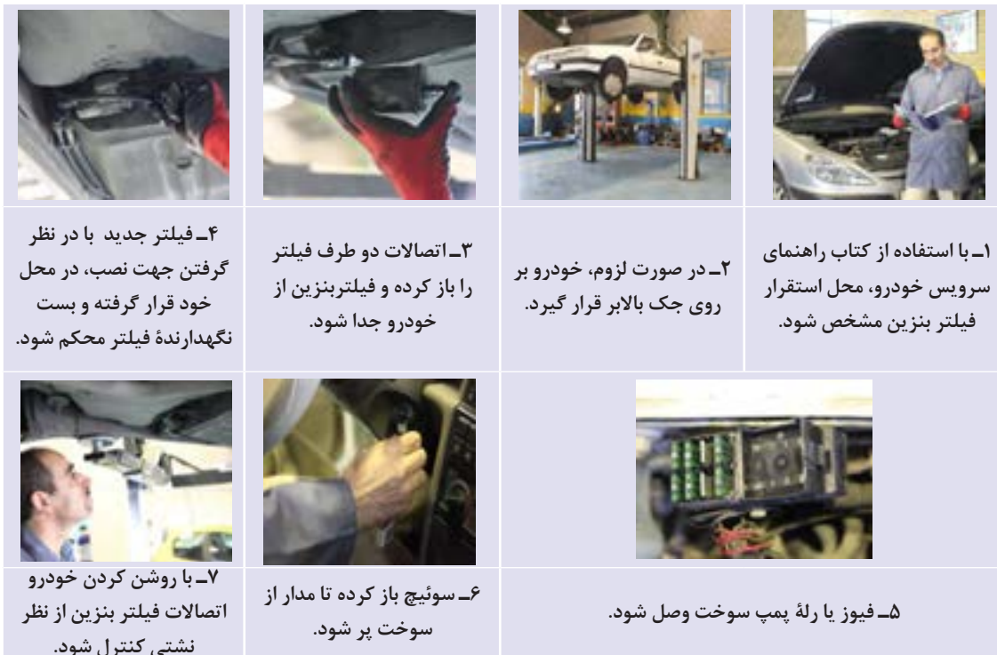
شکل ۳-۳۵ روش تعویض فیلتر بنزین
