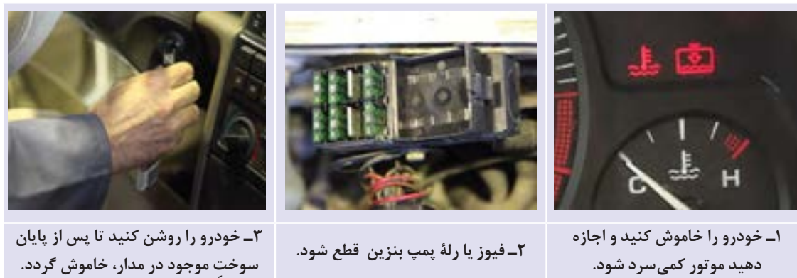
شکل ۳-۳۴ روش تخلیه فشار مدار سوخت رسانی
