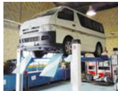
۱- خودرو روی جک بالا بر در ارتفاع مناسبی قرار گیرد.
