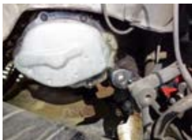
۲- پیچ ورودی روغن جعبه دنده باز شود.
