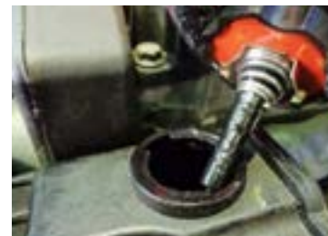
۸- دستگاه وکیوم از مخزن جدا شود و سطح مایع مخزن کنترل شده، در صورت لزوم به آن اضافه شود.
