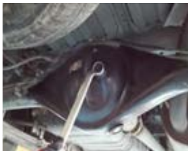
۲- پیچ ورودی روغن دیفرانسیل باز شود.
