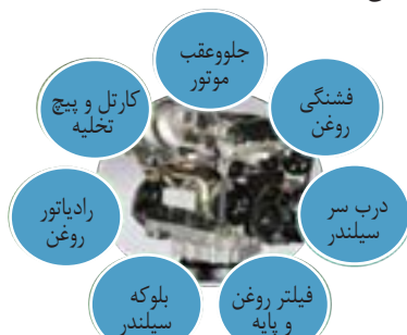
شکل ۵-۳- نقاط احتمالی بروز نشتی موتور
