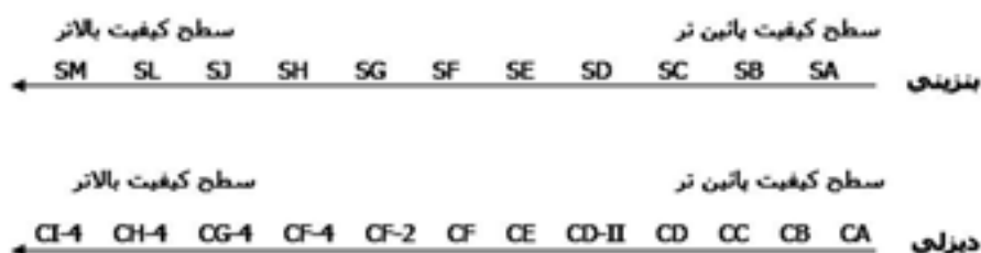
شکل ۳-۲۴ طبقه‌بندی روغن‌های موتور براساس کیفیت API
