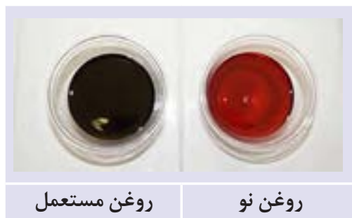
شکل ۵-۳ - مایع هیدرولیک فرمان نو و مستعمل
