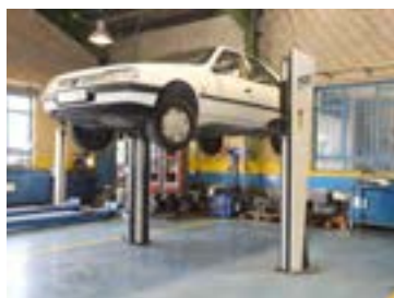
۱- خودرو روی جک بالا بر در ارتفاع مناسبی قرار گیرد.
