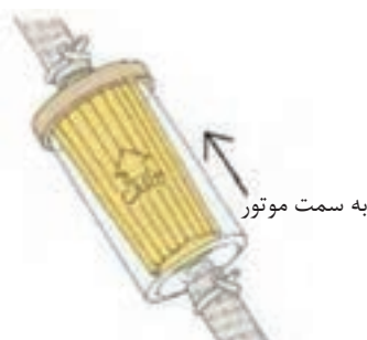
درج جهت روی فیلتر روغن
