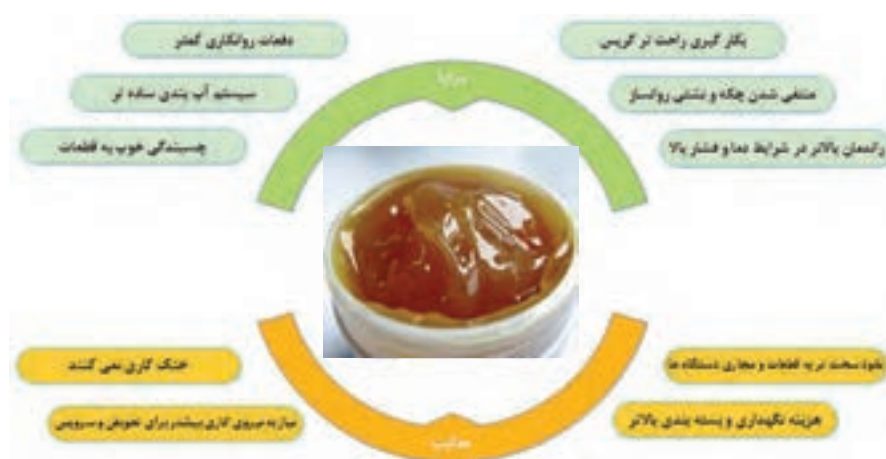
شکل ۵۲-۴- مزایا و معایب گریس ها نسبت به روانکارهای مایع
