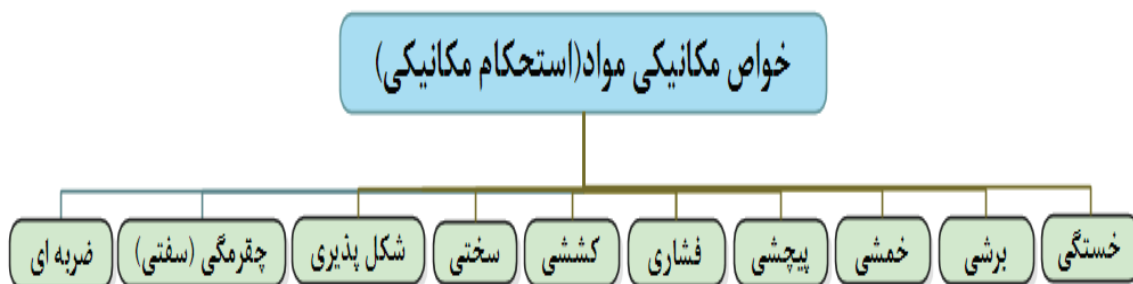
شکل ۴-۸- نمونه هایی از خواص مکانیکی مواد (استحکام مکانیکی)
