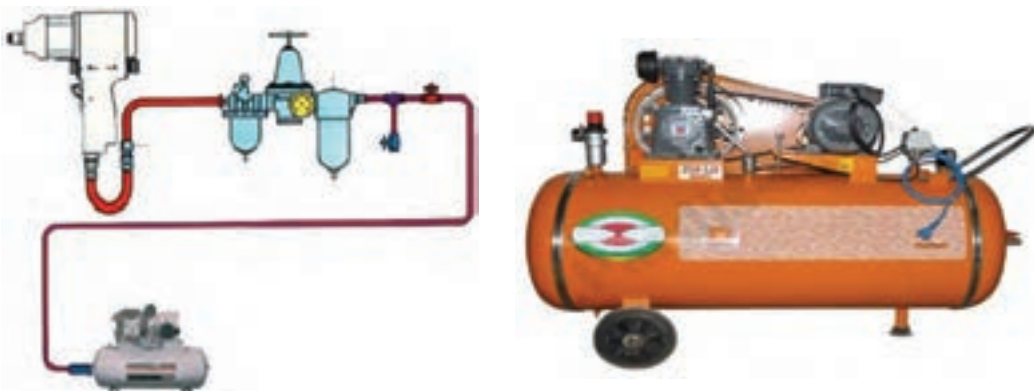
شکل ۹-۳- دستگاه کمپرسور و مدار پنوماتیک
