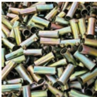
شکل ۲۹-۴ - نمونه‌ای از پوشش دهی کروماته
