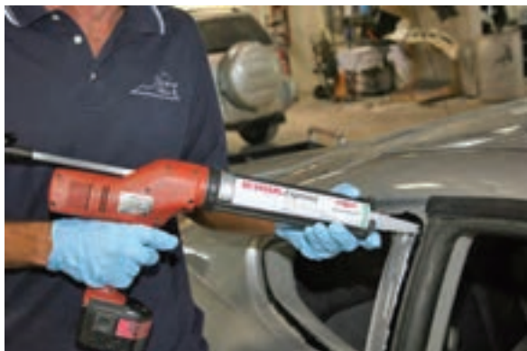
شکل ۴۱-۴- نمونه هایی از کاربرد چسب در خودرو
