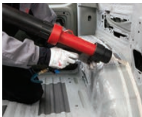
شکل ۴۱-۴- نمونه هایی از کاربرد چسب در خودرو
