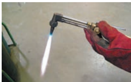
شکل ۱۱-۳- مشعل جوش گاز
