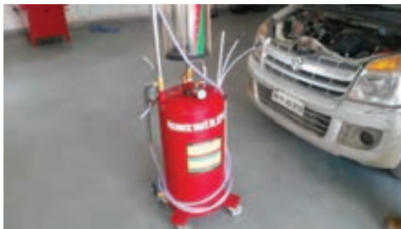
تعویض روغن موتور با ساکشن
