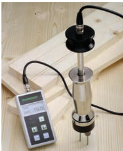
شکل ۳-۶- طرز کار با رطوبت‌سنج الکتریکی
