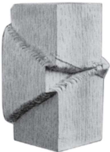
شکل ۹-۱ — شکست چوب در اثر نیروهای فشاری
