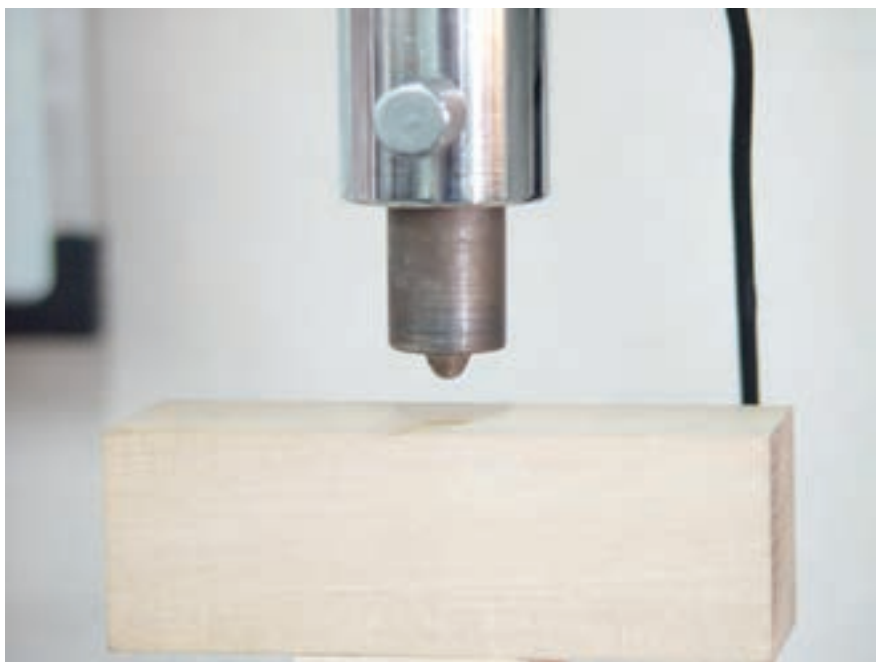
شکل ۱۱-۱- شمای وسیله سنجش سختی چوب
