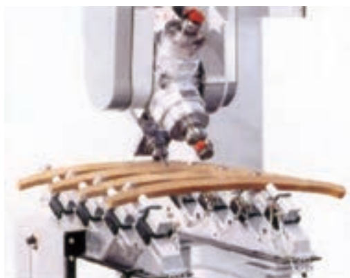
شکل ۱۸-۵- سوراخ‌زنی و کُم‌کُنی قطعات گرد و قوسدار به وسیله‌ی فرز کم‌کُنی و کم‌کُنی متغیر
