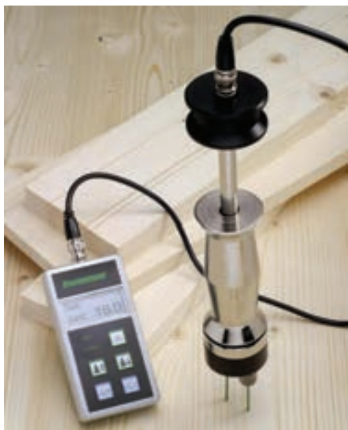
شکل ۳-۶- طرز کار با رطوبت‌سنج الکتریکی
