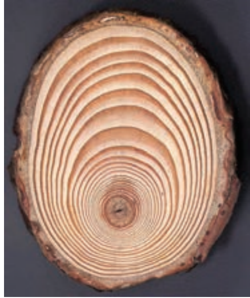
شکل ۷-۱- برش عرضی درخت سوزنی برگ: چوب نرمال در قسمت فوقانی و چوب فشاری در قسمت تحتانی دیده می شود.
