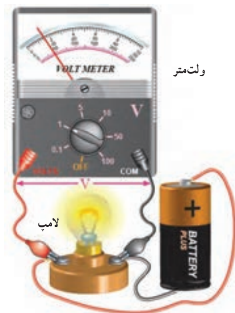
شکل ۹-۱۰- ولت متر در مدارات به صورت موازی با مصرف کننده قرار می‌گیرد.
