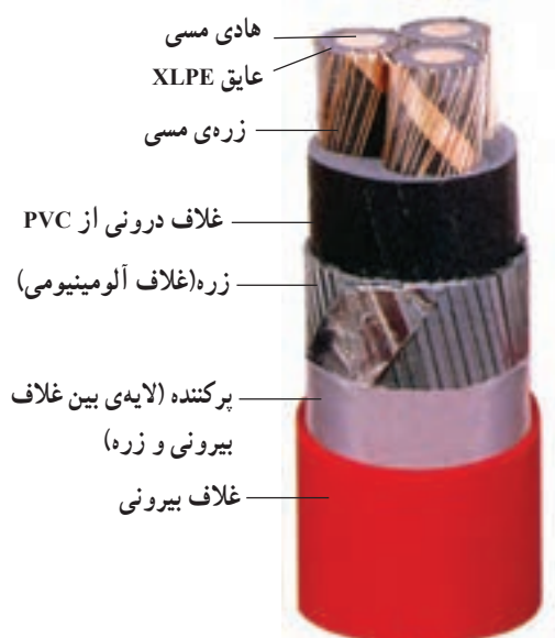
شکل ۳۹-۴ کابل با غلاف آلومینیومی
