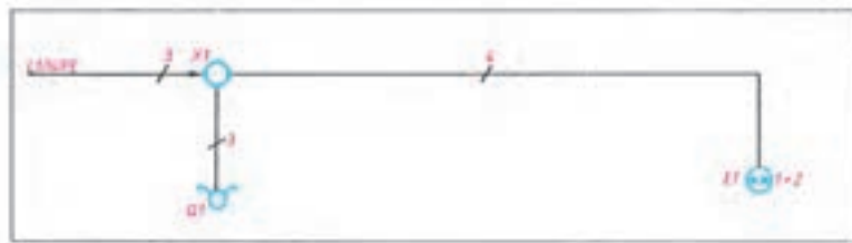
شمای فنی مدار کلید دوپل
