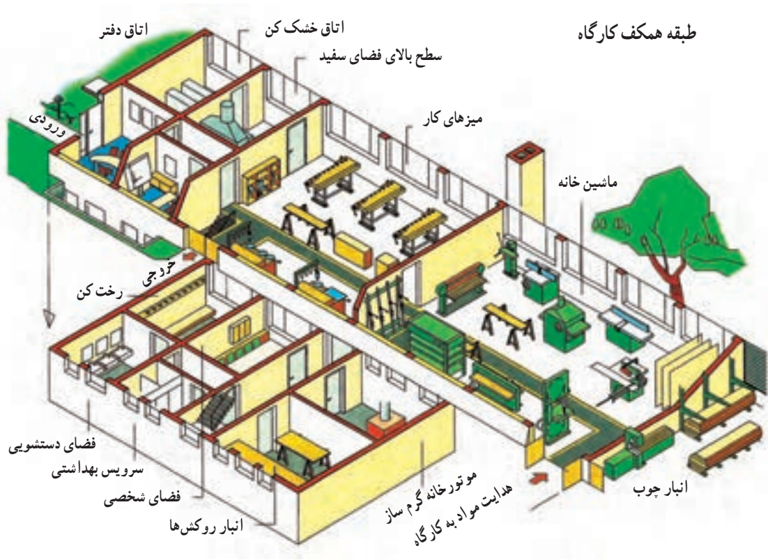
ماکت استقرار ماشین آلات و میزکار و مواد در تصویر مجسم از کارگاه بزرگ صنایع چوب
