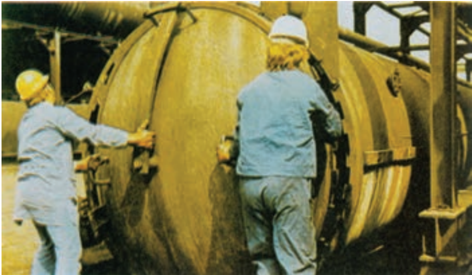
شکل ۶-۶- سیلندر در بسته آماده اشباع کردن چوب
