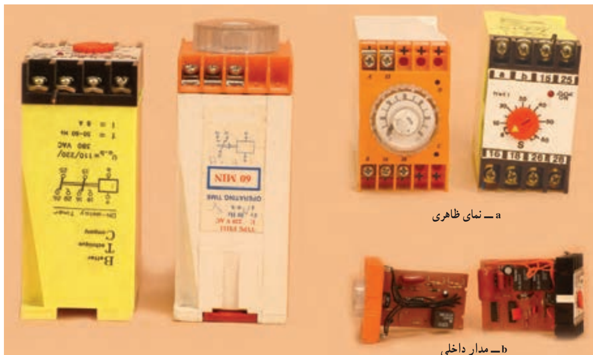
شکل ۸-۲۳- نمای ظاهری و مدار داخلی تایمر الکترونیکی
